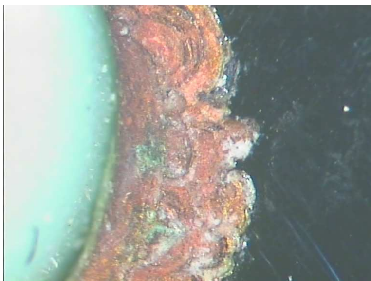
Abbildung 4: Mischergrundkörper: Messing/Nickel/Chrom Beschichtung wurde durch ein aggressives Medium abgelöst bis aufs Grundmaterial (Entzinkung erkennbar ).
