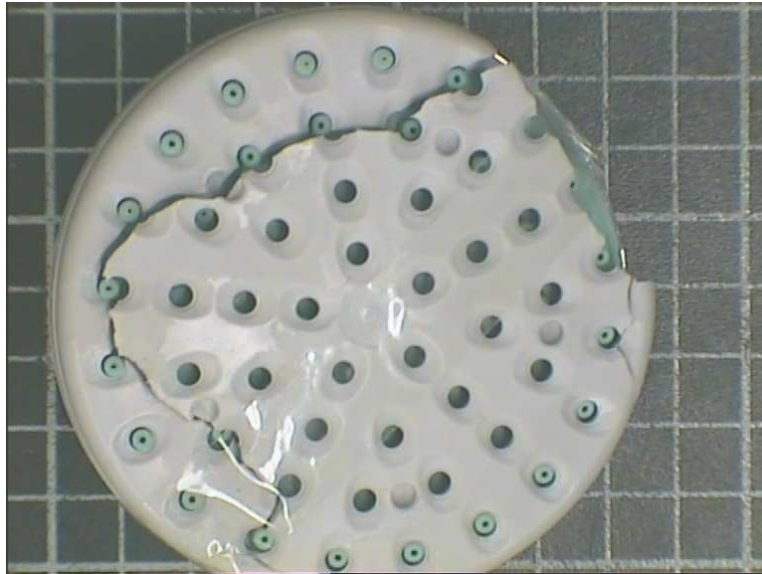
Abbildung 7: Stahlscheibe: POM (Polyoxymethylen) Spannungsrisse, ausgelöst durch ein aggressives Medium.
