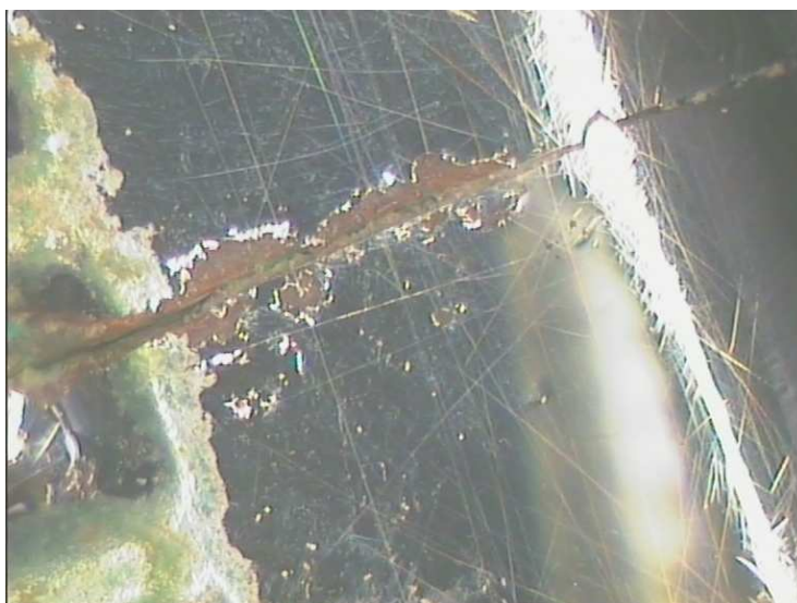
Abbildung 2: Auslaufrohr: Messing/Nickel/Chrom Spannungsriss ausgelöst durch ein aggressives Medium; Oberfläche auch mechanisch beschädigt, Kratzer deutlich sichtbar.
