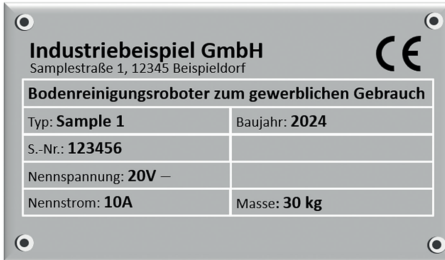
Abbildung 4: Typenschild nach Maschinenrichtlinie (Beispiel)
